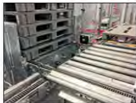
Rys.2 Oba kompaktowe moduły I/O RFID idealnie nadają się do aplikacji UHF w logistyce
