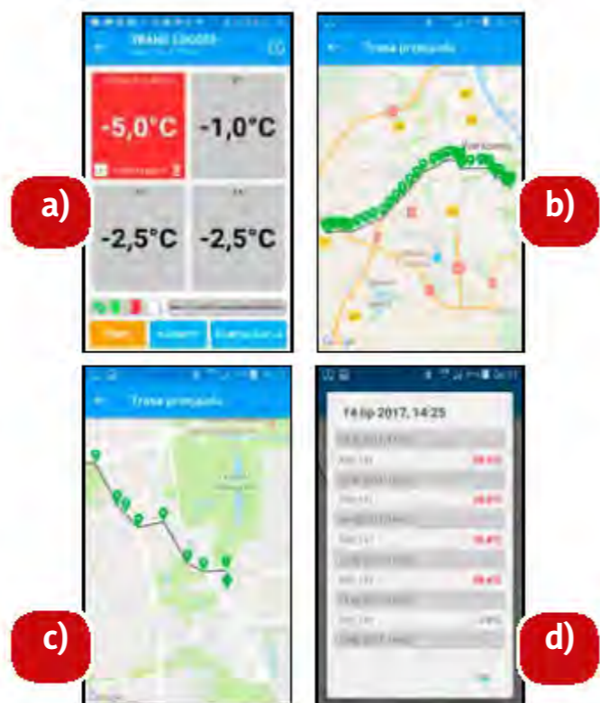
Rys. 2 a). Okno pomiarowe aplikacji Trans-Logger; b). trasa przejeżdżana z Reguły (siedziba firmy LAB-EL), do Warszawy na ulicę Belwederska 14 (długość trasy ok. 14 km); c). powiększony końcowy fragment trasy; d). wyniki pomiarów w konkretnym punkcie trasy - cztery temperatury i czas otwarcia drzwi
