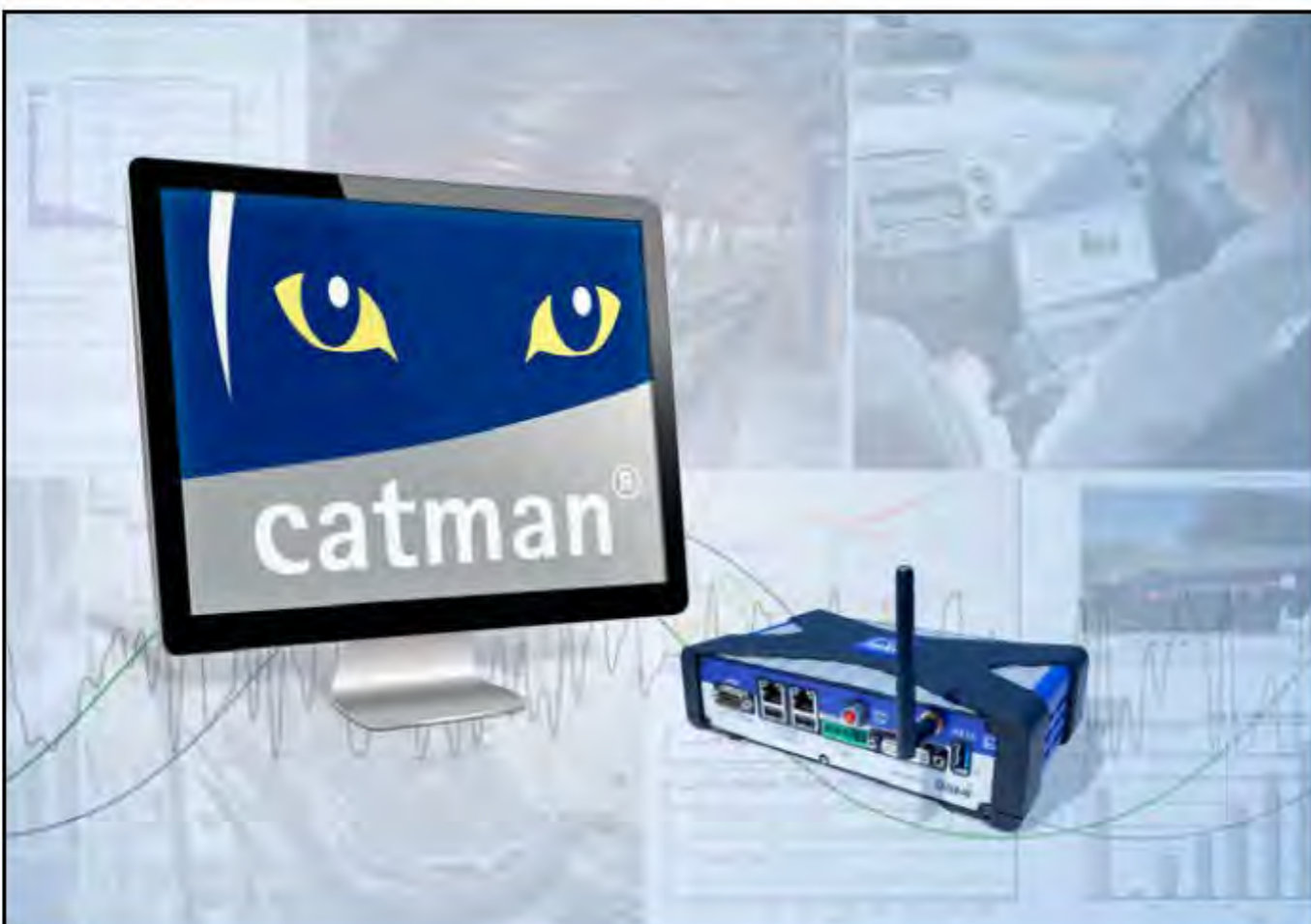
Niezbędne do monitorowania stanu konstrukcji: rejestrator danych QuantumX CX22B-W i oprogramowanie Catman
