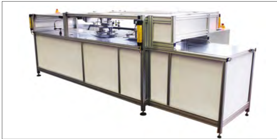
Rys. 1. Automatyka krajalnica marki Somix wyposażona w rozproszony układ sterowania oparty o moduły TBEN-L
