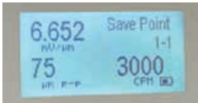
Przełny kalibrator drgań, model 9110D pomaga odkryć błędy wywołane przez okablowanie sondy zbliżeniowej.
