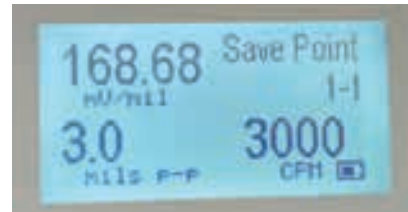
Przełny kalibrator drgań, model 9110D pomaga odkryć błędy wywołane przez okablowanie sondy zbliżeniowej.
